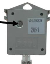
Weicht die angezeigte Zeit im Betrieb um eine Minute ab, muss zum Wechseln der Polarität, die Anschlusskupplung gedreht werden.
