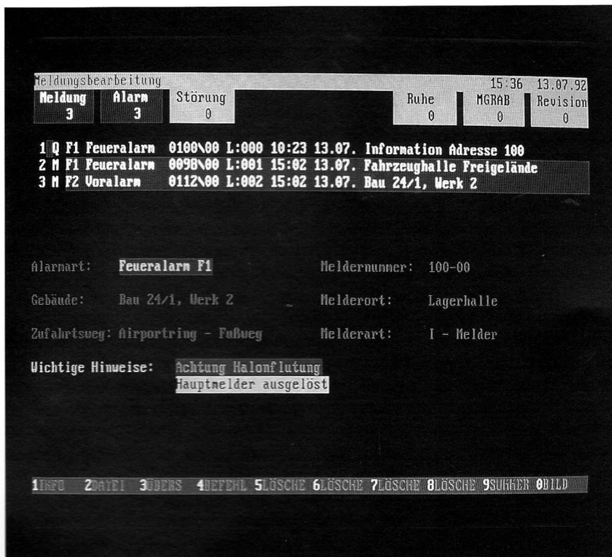
Bild 5 Monitor Darstellung einer Meldung mit Kurzinformation und Klartext
